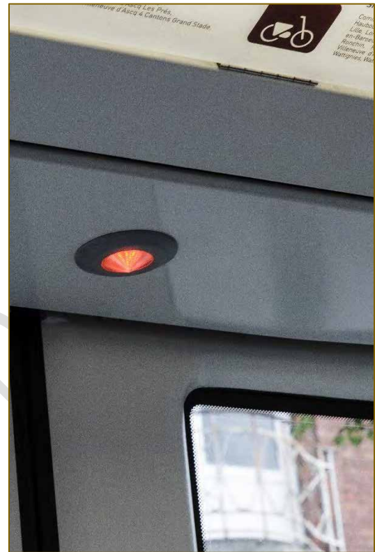
Figure 5 - photographies de l'affichage dynamique à bord du tramway et du témoin lumineux prévenant de la fermeture des portes.
